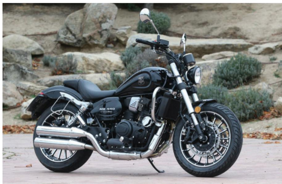
O motor é um bicilíndrico de 389cc refrigerado por líquido, com uma potência
