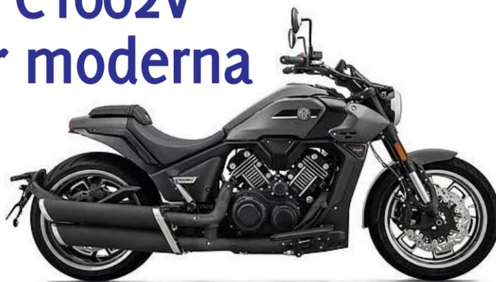
permite-lhe uma fantástica resposta e acelerações emocionantes. Dois discos de travão com 320mm na roda dianteira e um na roda traseira de 300mm e tudo com ABS, conferem-lhe uma excelente capacidade de travagem.
