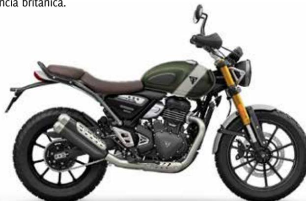
O motor é um monocilíndrico de 398 cc, com cabeça de 4 válvulas, com injeção e refrigeração líquida, debitando 40 cv de potência máxima e 37,5 Nm de binário. A gestão do motor é *Bosch*, dispondo de um acelerador "ride by wire", o que deverá permitir uma resposta intuitiva e previsível. Também o ABS é um *Bosch* de dois canais, que pode ser desativado na *Scrambler*, para percursos fora de estrada.
