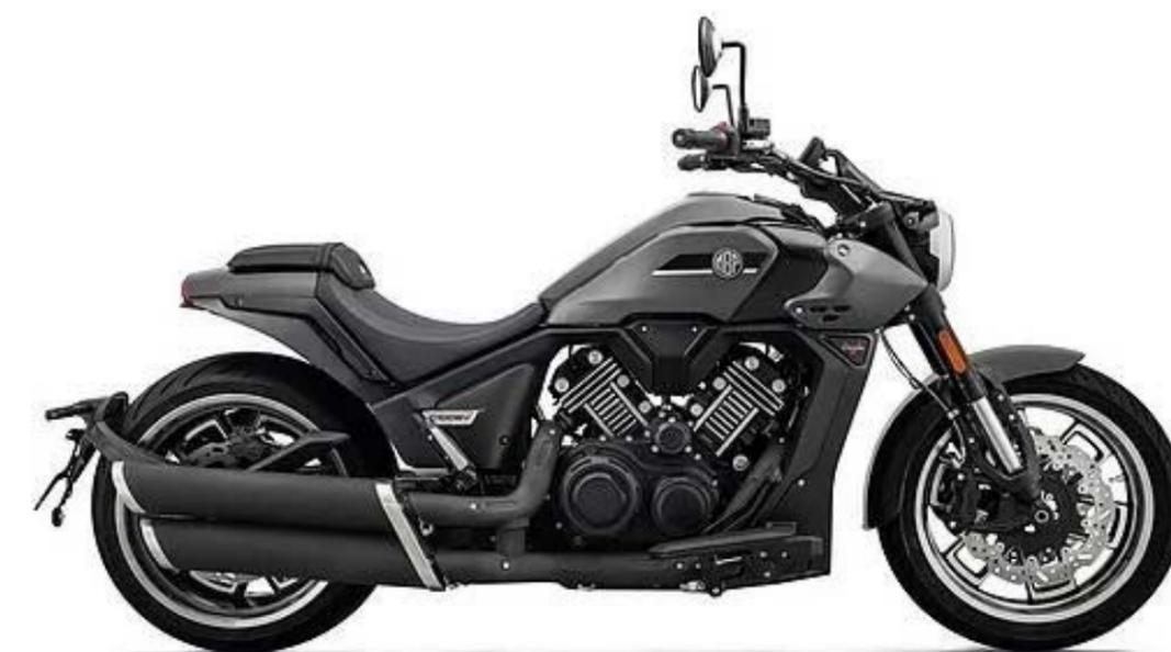
O seu navio almirante é, para já, uma cruiser impactante de estilo e design, a C1002V. A designação vem do seu impressionante motor de dois cilindros em V, com uma cilindrada de 997 cc, debitando 87,2 cv de potência e 89 Nm de binário. Esta força permite-lhe uma fantástica resposta
